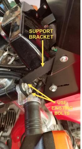
REMOVE THE RIGHT FORK CLAMP BOLTS. INSTALL THE SUPPORT BRACKET AS SHOWN USING THE STOCK BOLTS.
